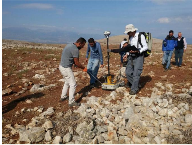
Resim 3 Hatay İli, Kırıkhan İlçesi, Muratpaşa-Kızılkaya sahası Kızılkaya 1 kurganında GPR ölçümü
