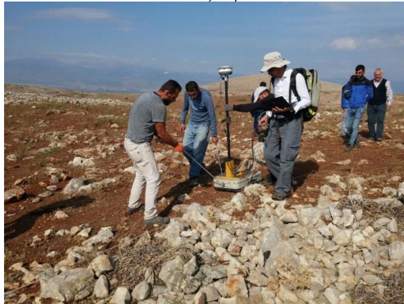
Resim 5. Hatay İli, Kırıkhan İlçesi, Başpınar Antepli Tepesi sahası Antepli Tepe 1 kurganında GPR ölçümü.
