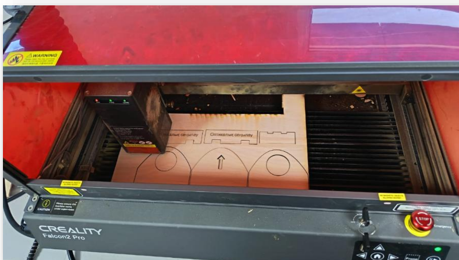
2-сурет – CREALITY Falcon2 Pro құрылғысында лазерлік кесу процесі
